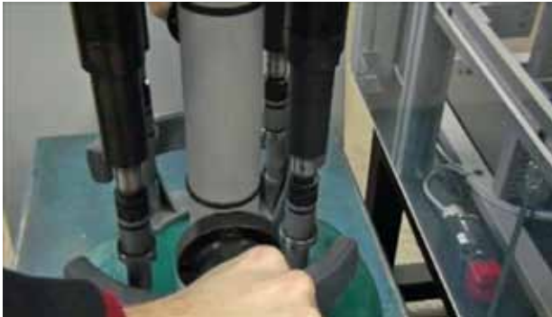
Stazione di pescaggio che viene traslata automaticamente sulla linea a pallet per il prelievo dei 4 dadi
