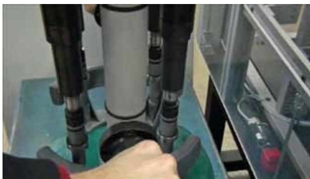
Poste de prise écrous qui est ensuite déplacé automatiquement au-dessus de la bande d'amenage des bouteilles
